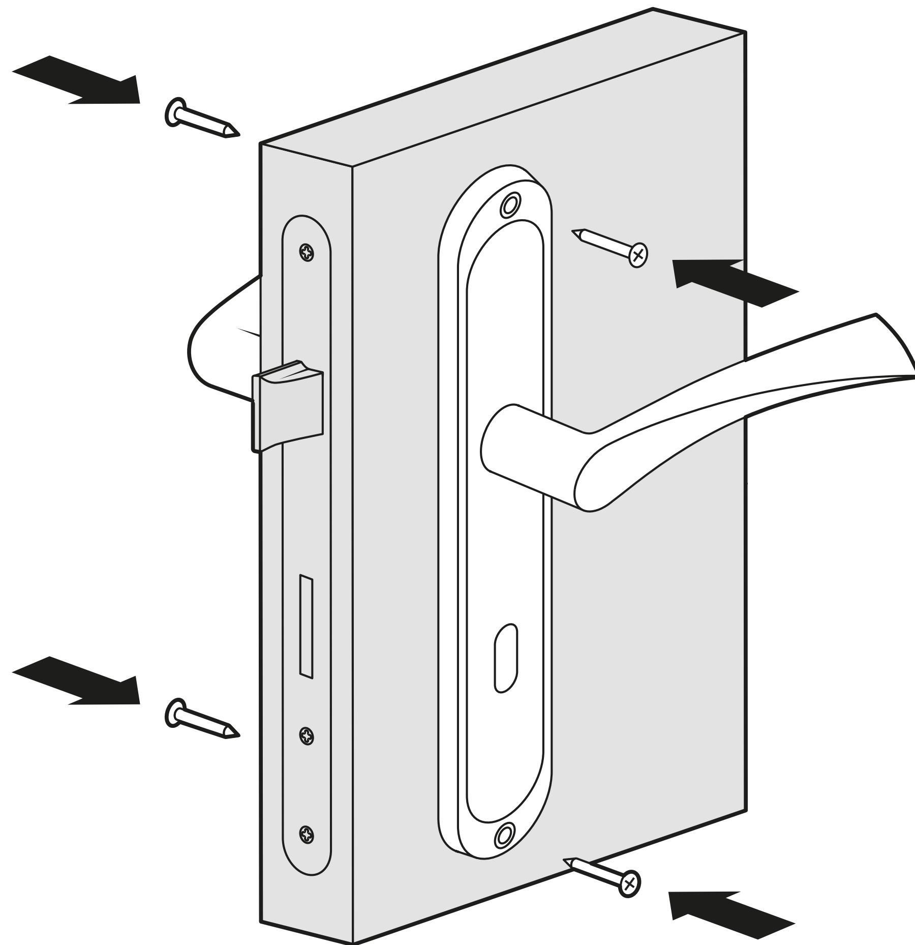
**PL:** W zależności od zawartości zestawu montażowego dokręcić dwie sztuki klamek za pomocą wkrętów do drewna lub śrub przelotowych (operacja 1.5).
