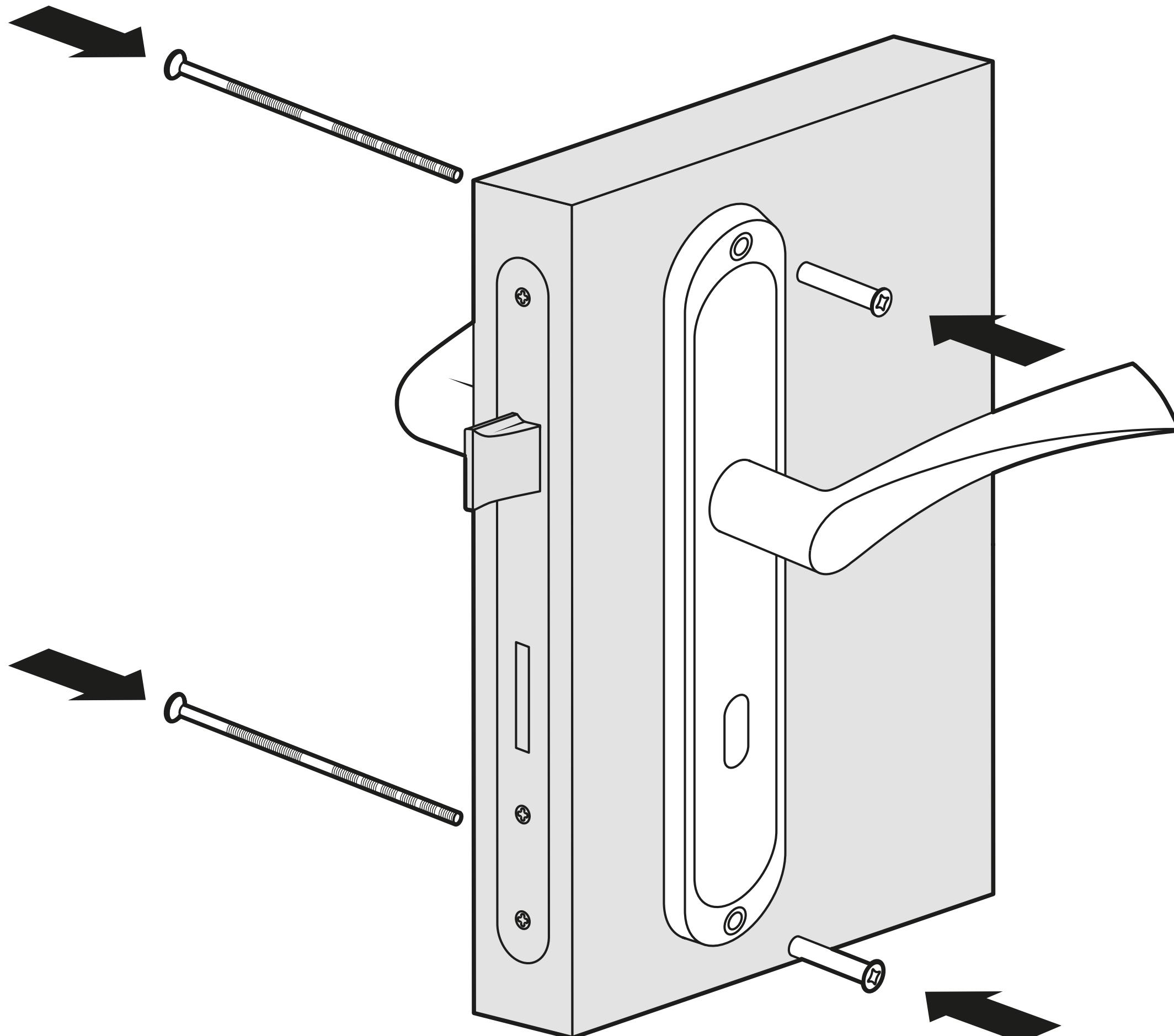
**PL:** W zależności od zawartości zestawu montażowego skręcić dwie sztuki klamek za pomocą śrub przelotowych lub wkrętów do drewna (operacja 1.6).
