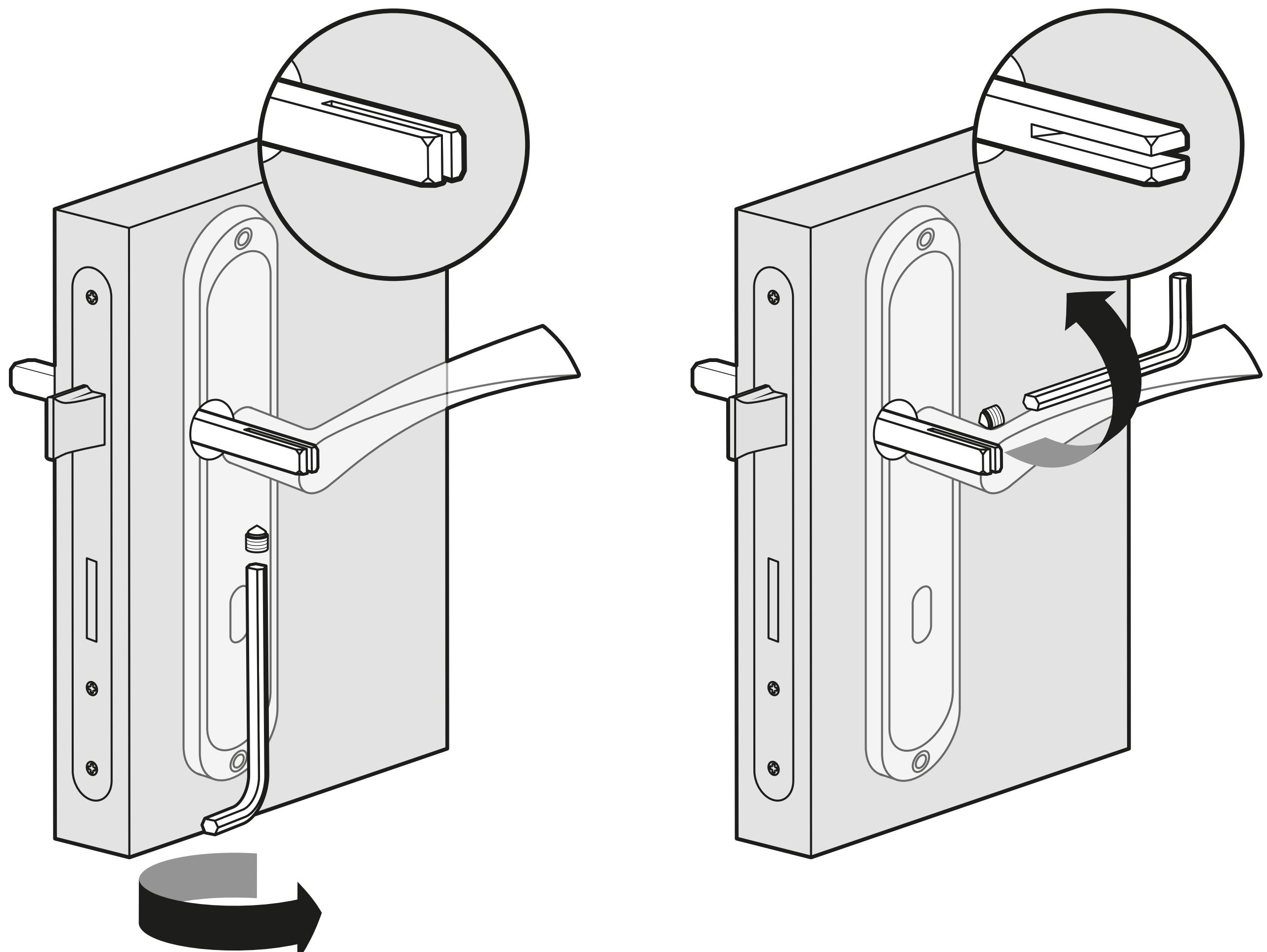
**PL:** W zależności od konstrukcji klamki i kierunku nacięcia w trzepieniu zamontowanym uprzednio w zamku należy mocno dokręcić śrubę imbusową od dołu lub boku klamki.
