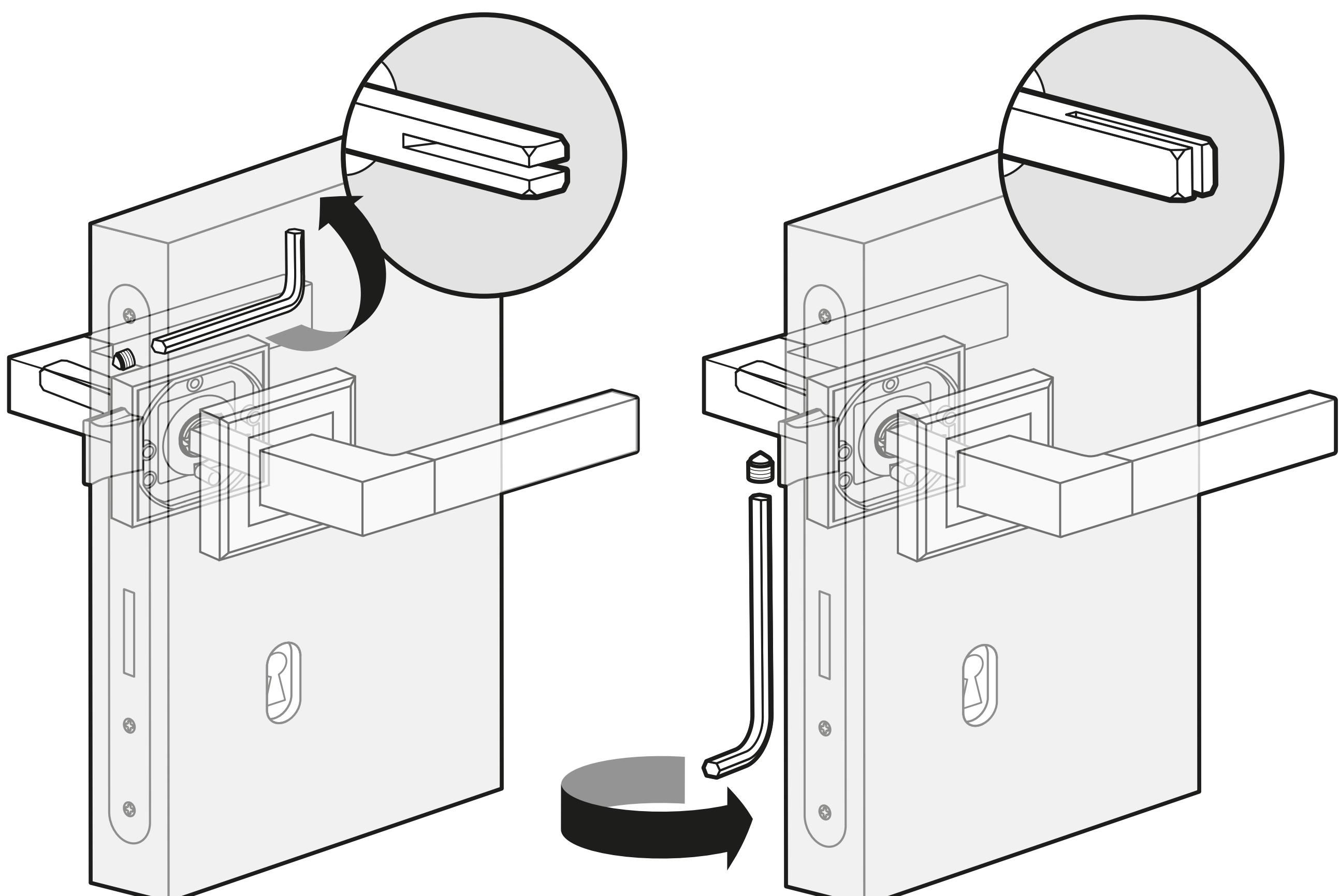
**PL:** W zależności od konstrukcji klamki i kierunku nacięcia w trzepieniu zamontowanym uprzednio w zamku należy mocno dokręcić śrubę imbusową od dołu lub boku klamki.
