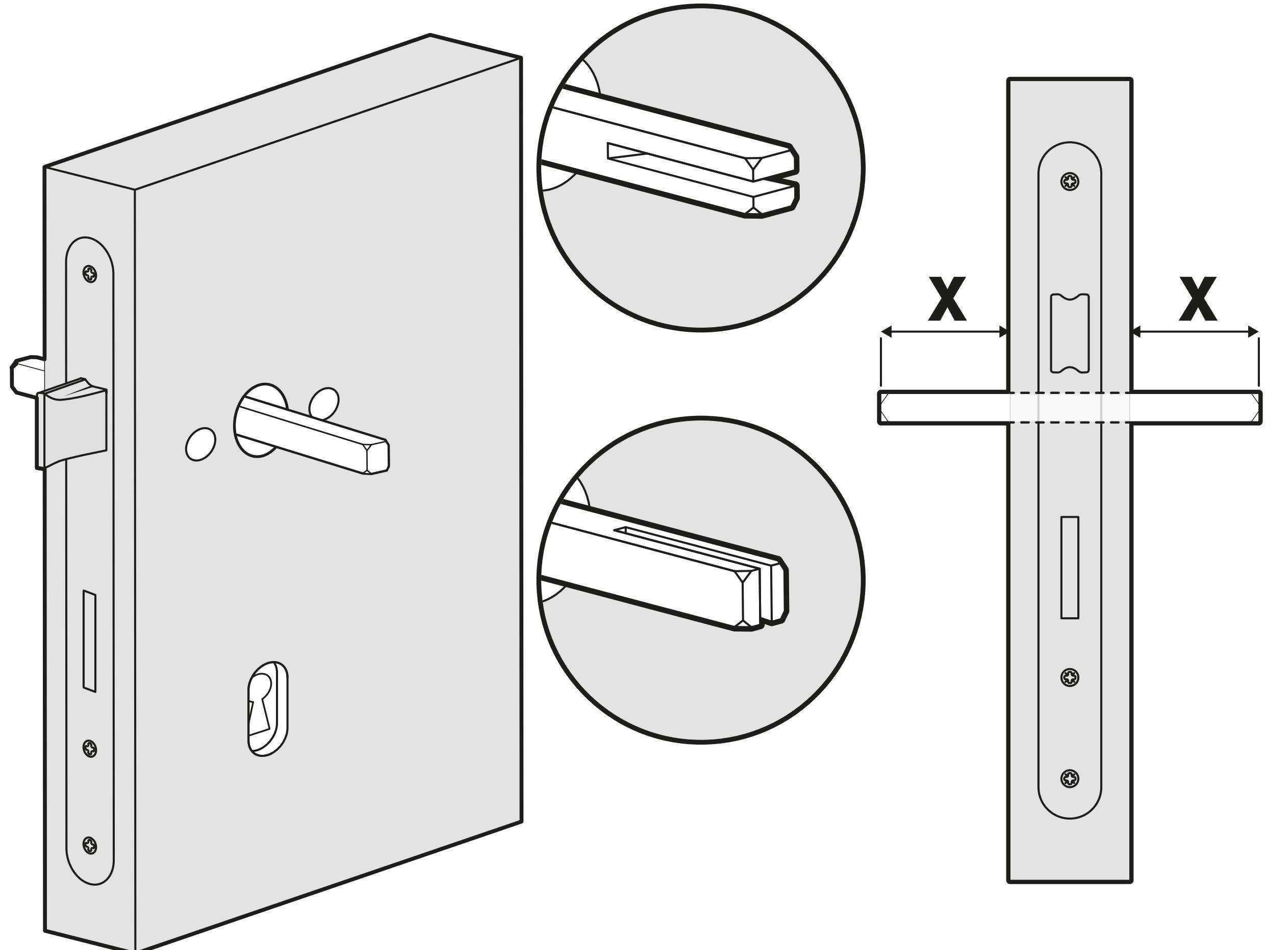
**PL:** Wsunąć trzpień symetrycznie do zamka zamontowanego w drzwiach, ustawiając nacięciem w odpowiednim kierunku w zależności od konstrukcji zastosowanej klamki.
